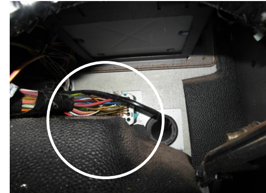
Kabel für V-Signal, können bei einigen Fahrzeugen auch am 34 oder 42 poliger Stecker vor dem Sicherungskasten Pin 13 abgenommen werden
