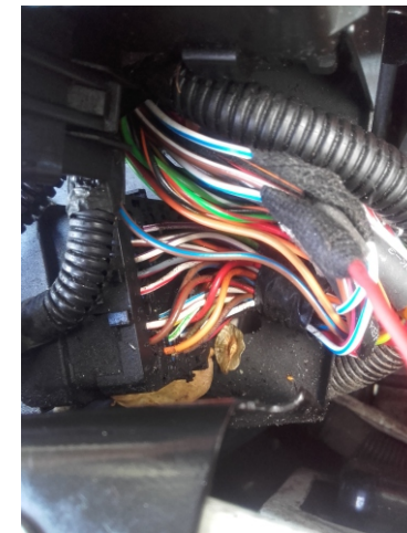
Alternativ: Stecker am Sicherungskasten im Motorraum Pin 13 Blau/Weißes Kabel
