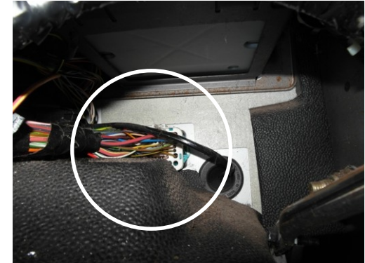
* Rot/Gelbe Kabel nur bei Fahrzeugen mit man. Schaltung anschließen. Andernfalls auf Masse legen.
