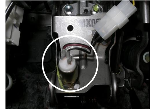
Entfernen Sie den 12mm Bolzen und nutzen den beigelegten 10mm Kupplungsschalter. Justieren Sie den Schalter auf gleicher Höhe wie der ausgebaut Bolzen.
