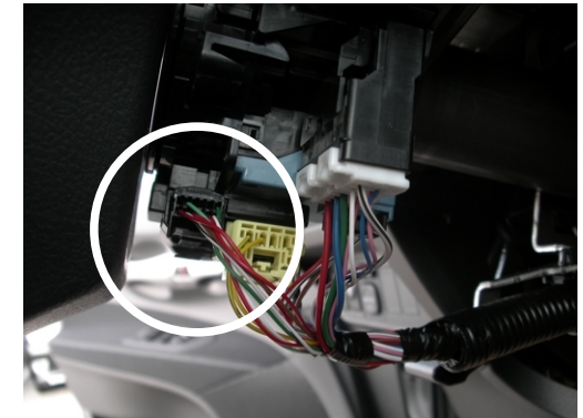
Die beiden Kabel in Position 1 & 2 schneiden. Schwarz und Weiß/Lila Kabel, wie gezeigt auflöten.
