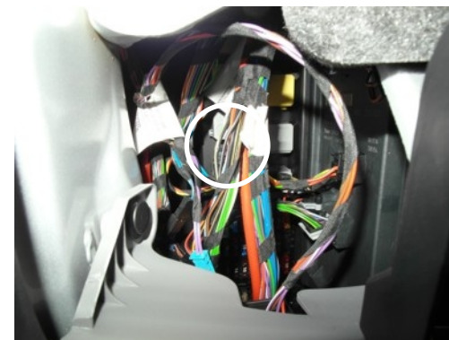
Zündung +15 kann alternativ abgenommen werden: Zündschloss, Schwarzer 6-Pin Stecker, Pin 2, Schwarzes Kabel.
