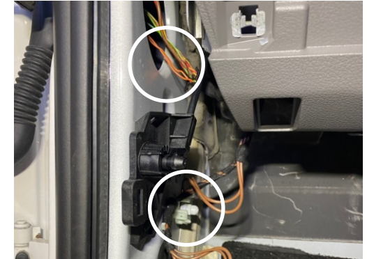
Canbus Kabel und Masse befinden sich an A-Säule auf der Fahrerseite, Orange-Grün kann auch Grün sein.
