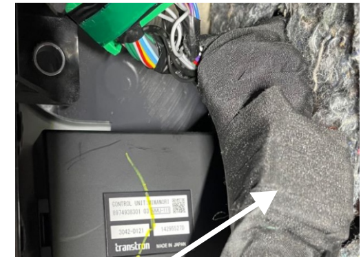
Stecker neben dem Kupplungspedal. Teilweise mit dem Kabel zusammen umwickelt.
