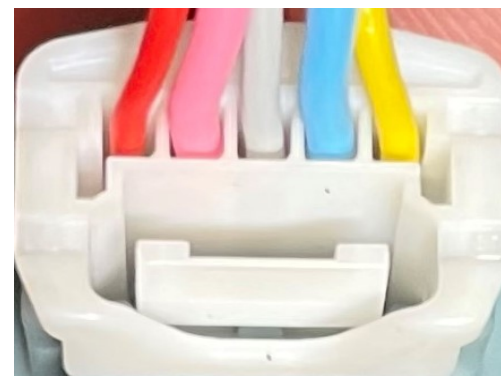
Gelbes Kabel am Bremslichtschalter - Pin 5 (Zündung)
