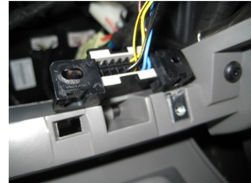
OBD Buchse unter dem Handschuhfach
