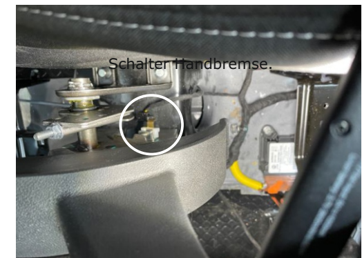
Grünes Kabel an Handbremsschalter anlöten.
