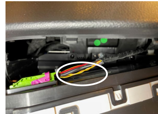
CAN Bus befindet sich hinter dem Kombiinstrument.
