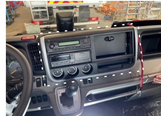
Entfernen Sie den Rahmen, um Zugang zu Klemme 15 (Zündung) & Can-Bus zu erhalten.
