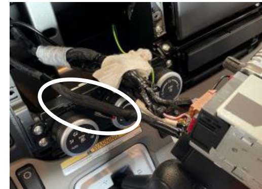
Die Can-Bus Kabel finden Sie in diesem Kabelbaum.
