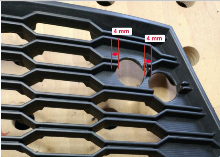
Von der Rippe je Seite ca. 4mm entfernen (zum Beispiel vorsichtig mit einem Cuttermesser), damit der Haltering ohne Spannung sitzt.
