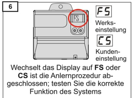
\* **Wichtig:** Das Selbst-Anlern-Verfahren **muss** innerhalb einer Minute nach der ersten Spannungsversorgung des Frontmoduls ausgeführt werden, sonst erfolgt keine Codeübertragung der Modul-ID. Wird die Zeit überschritten, müssen Sie den Vorgang von Punkt D1 wiederholen. (Einfach Batterie kurz abklemmen oder Steckverbinder des Funkmoduls lösen.)
