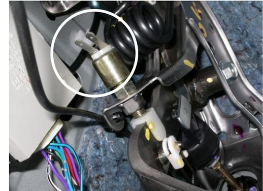
Der Pedalanschlag wird gemessen und durch den enthaltenen Kupplungsschalter ersetzt. Der Kupplungsschalter muss in der selben Position wie der Anschlag sitzen.
