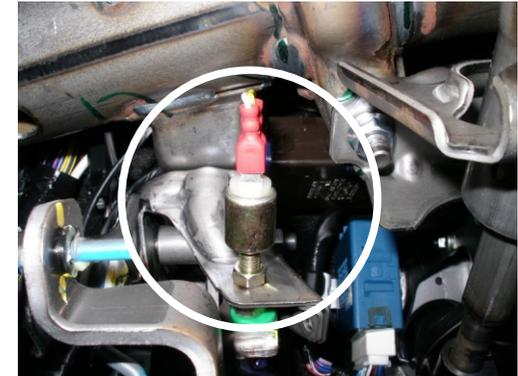
Den beigelegten Kupplungsschalter so montieren,
