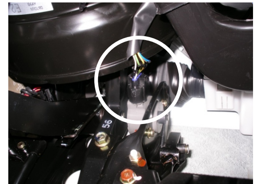
Den beigelegten 120 Ohm Widerstand auf das Orange Kabel und auf Masse löten.
