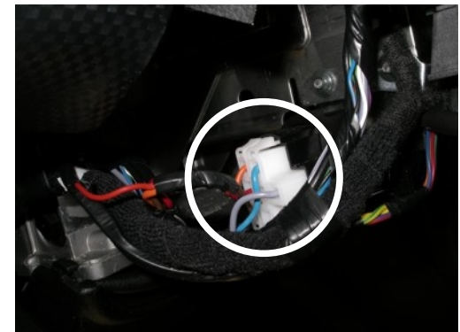
Stecker hinter Zündstartschalter (Von der Kabelseite aus betrachtet)
