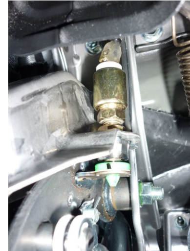
Schalter so verbauen, dass bei nicht getretener Kupplung der Schalter komplett betätigt ist.
