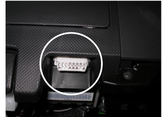
Demontieren Sie den originalen OBD Stecker von der Bremse und schließen Sie das beiliegende Y Kabel an. Montieren Sie das andere Ende des Y Kabels an die Bremse.
