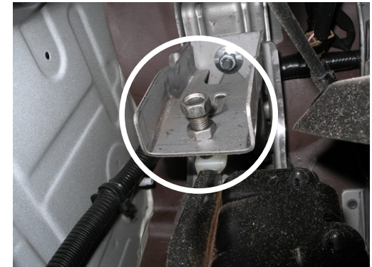
Der Kupplungsschalter ist so zu justieren wie der bisherige Pedalstopp.
