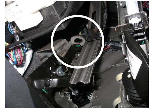
der Kupplungsschalter muss den gleichen Anschlag haben wie der vorherige Kupplungsstop. (messen sie den Kupplungsweg)
