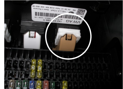
Hellbrauner Stecker am BCM T 52 C (verdrillte Leitungen i.d.R. Pin 15 & 16)
