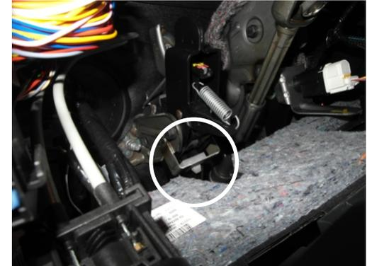
Plasteteil entfernen, 10mm
