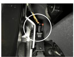
\* Führungsnuten abschneiden. (Pedal lösen, lässt sich besser montieren).
