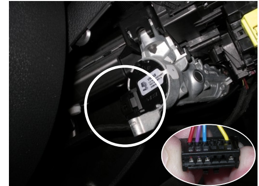
Kabelfarben können variieren. Ist aber selbe Position.
