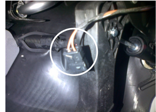
12-poligen Stecker nur bei 2.0 L Motor nutzen
