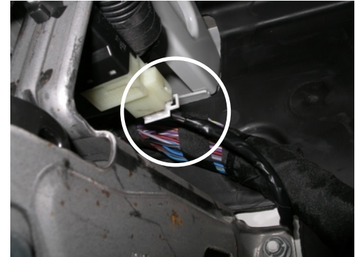
Zündung +15 kann alternativ abgenommen werden: Zündschloß, Schwarzer 6-Pin Stecker, Pin 2, Schwarze Kabel. ISO Stecker hinter Radio Pin 7- Schwarz/Gelb (Vito & Viano)
