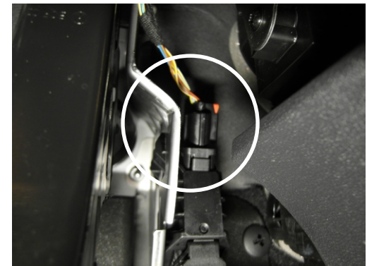
* Führungsnasen am beiden Steckern entfernen. (Pedal lösen um besser montieren zu können).
