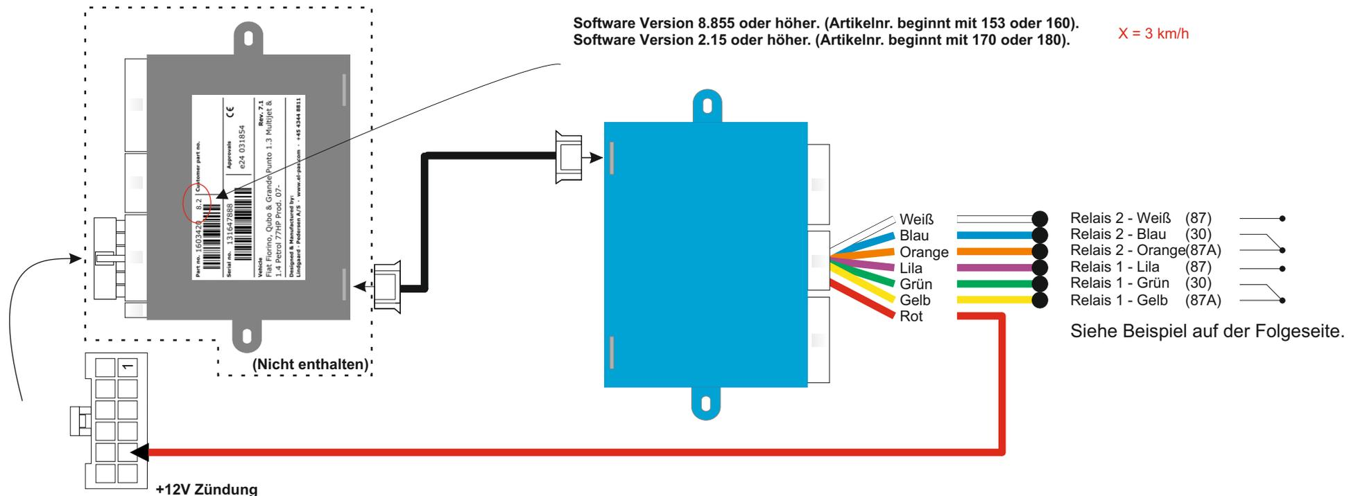
Das Steuermodul muss auf das gewünschte Limit programmiert werden
