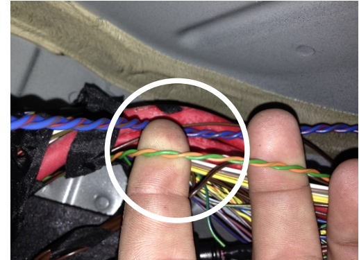
Can kan Alternativ vom FEM-Modul Weisser Stecker hinter dem Handschuhfach abgenommen werden.
