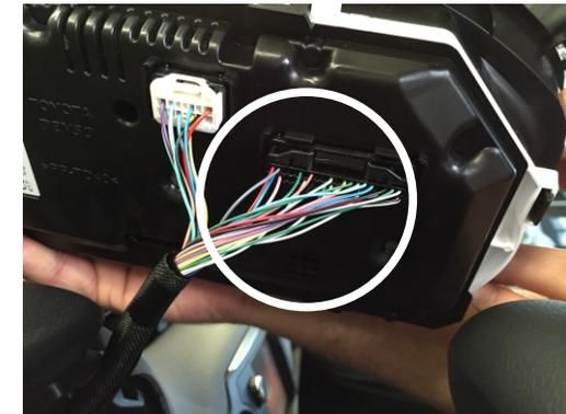
Schneiden Sie das Rote & Schwarze vom OBD-Y-Kabel ab und löten Sie die Enden wie auf der linken Seite gezeigt auf den Can-Kabeln am Kombiinstrument an.
