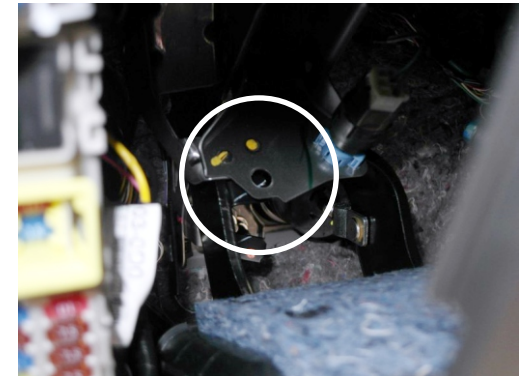
Schalter so justieren das Kupplung aktiviert ist wenn Pedal in Ausgangsstellung.
