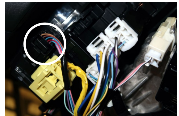
12-poliger Stecker unter Lenksäule (von Kabelseite aus betrachtet)
