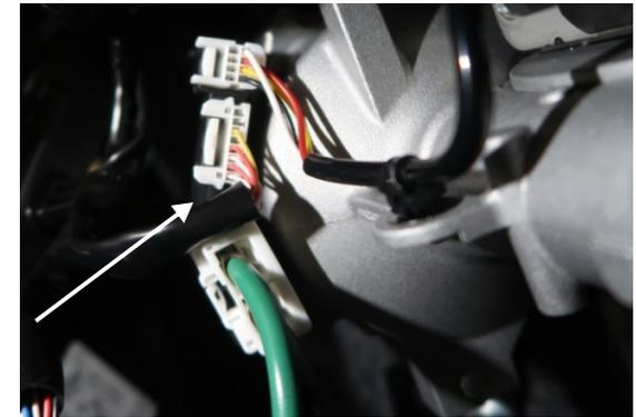
Stecker am Steuergerät der Servolenkung. Befindet sich an der Lenksäule, nutzen Sie die zwei untern Kabel im Stecker.
