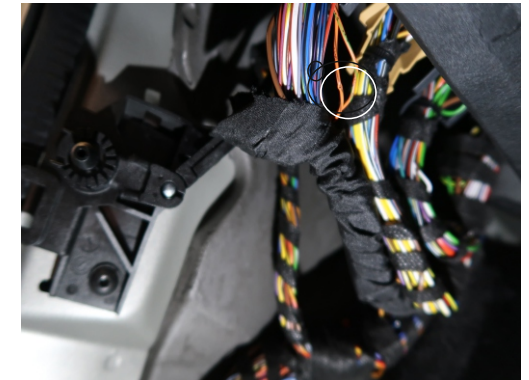
Schwarzer Stecker (weißer Einsatz) 73-polig über der linken A-Säulen-Verkleidung PIN 46 & 47
