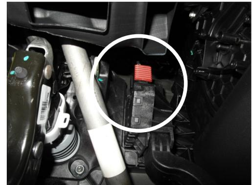
Bitte beachten Sie, dass der Stecker eine Codierung hat und nur auf eine Weise angesteckt werden darf. Ein gewaltsames 180° Verdrehen führt zu einem Gaspedalfehler.
