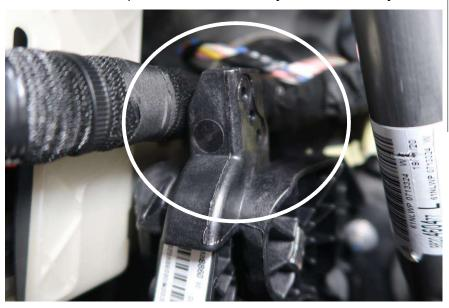
Kupplungsschalter auf der Rückseite montieren, Kabel nach oben.
