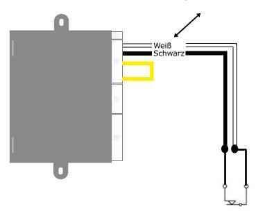
"2-poligen Stecker vom Kupplungsschalter abschneiden und mit schwarzem und weißen Kabel verlöten.
