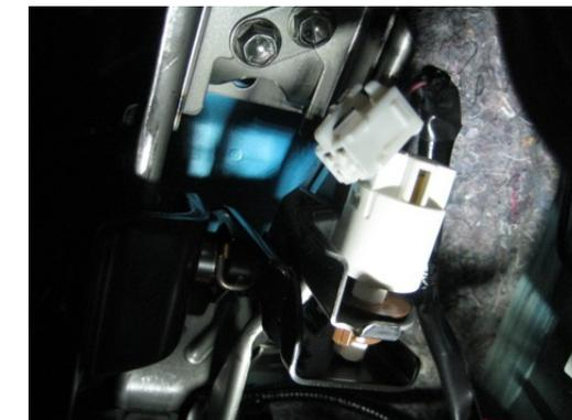
Löten Sie das rote Stromversorgungskabel an das hellgrüne Kabel am Bremslichtschalter.
