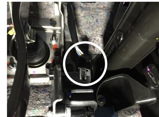
Stecken Sie das Gaspedalkabel zwischen Gaspedal und Fahrzeugkabelbaum.
