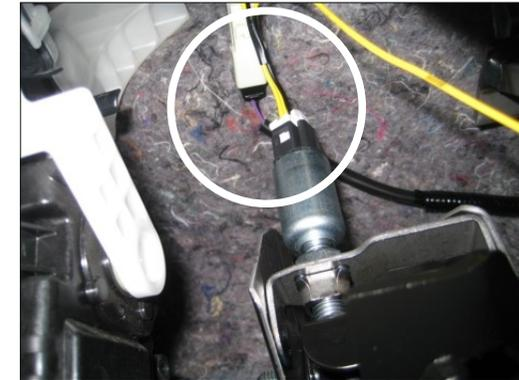
Löten Sie das gelbe Kupplungskabel an das lila Kabel am Kupplungsschalter.
