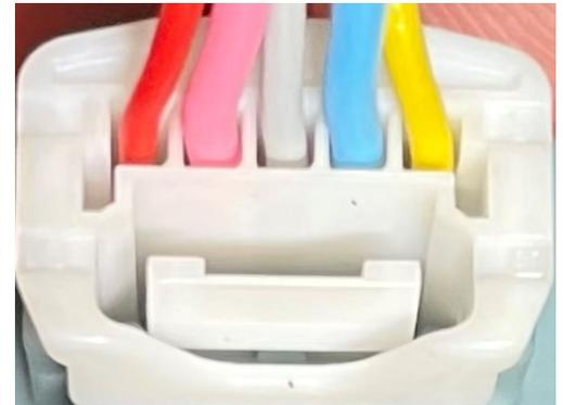
Gelbes Kabel am Bremslichtschalter - Pin 5 (Zündung)
