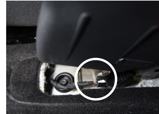
Schalter unter dem Handbremshebel Das Kabel finden Sie ebenso an Pin 25 des Tachosteckers.
