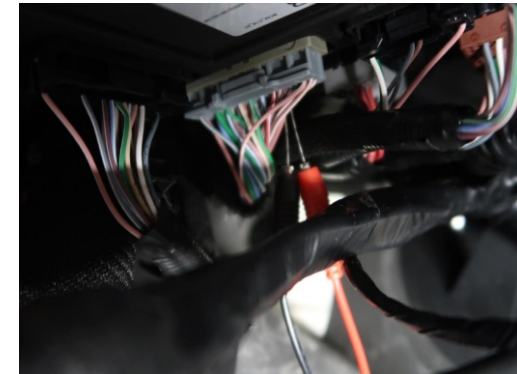
40 Pin Stecker am BCM, oberhalb der unteren Plastikabdeckung. (von unten gesehen).
