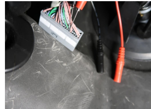
Stecker zur Vereinfachung des Einbaus abziehen, Stellen Sie sicher, die korrekten Kabel zu nutzen, da es auch andere, gleichfarbige Kabel
