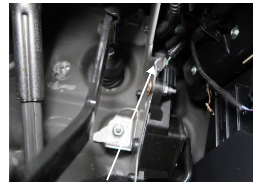
Stecker zur Vereinfachung des Einbaus abziehen, Stellen Sie sicher, die korrekten Kabel zu nutzen, da es auch andere, gleichfarbige Kabel
