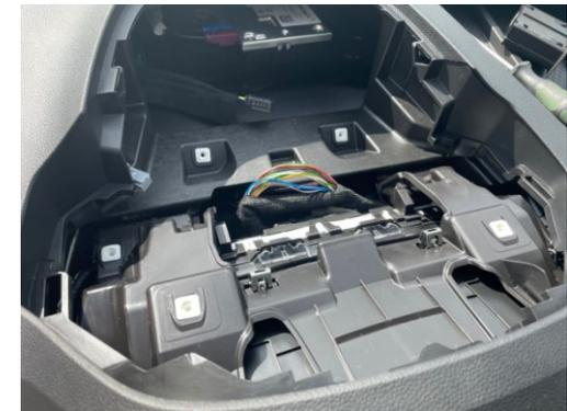
CAN Bus Kabel befinden sich im Kabelbaum hinter dem Kombiinstrument
