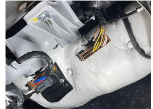
CAN Bus Kabel befinden sich in einem braunen Stecker, unter dem Armaturenbrett, hinter dem Sicherungskasten.
