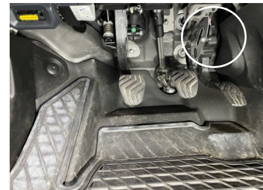
Für die Montage des Y-Gaspedalkabel ist es hilfreich das Gaspedalpoti zu demontieren.
