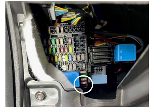
Klemme 15 (Zündung) Rote Kabel auf Rückseite des Sicherungskasten. (Weißer Feil markiert das Kabel)
