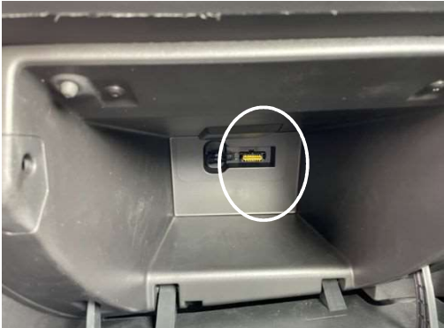
Handschuhfach ausbauen um Zugang zum OBD Stecker zu erhalten. Can Kabel anlöten !!! Pin 6 (CAN high) & Pin 14 (CAN low)
