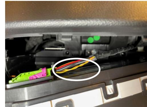
CAN Bus befindet sich hinter dem Kombiinstrument.
