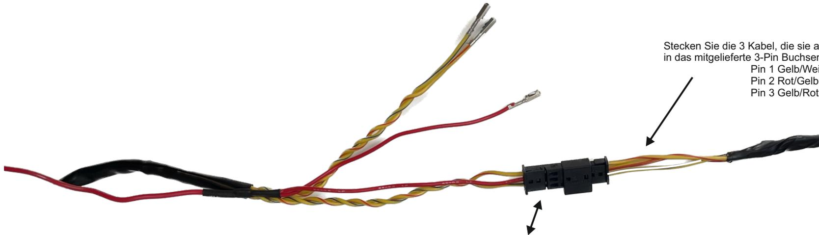
Stecken Sie die 3 Kabel, die sie ausgepinnt haben, in das mitgelieferte 3-Pin Buchsengehäuse:
