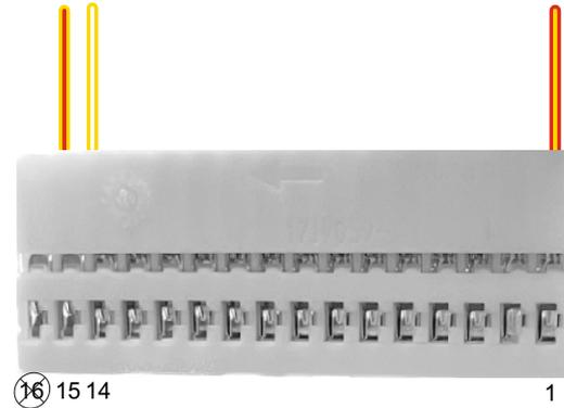
Stecken Sie die 3 Kabel vom E-Cruise in Pin 1, 14 & 15, wie unten beschrieben.
