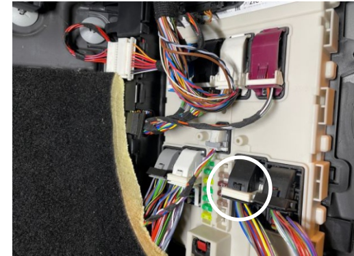
BCM in der rechten A-Säule Trennen Sie den Stecker, lösen Sie den blauen Teil und pinnen Sie den Pin in Pin 2. ( Zündung)
