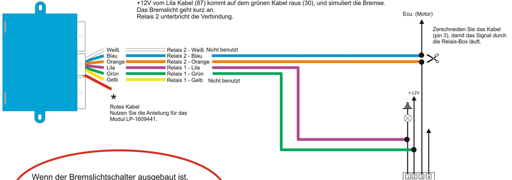
Wenn der Bremslichtschalter ausgebaut ist, achten Sie bitte darauf, beim erneuten montieren das Pedal nicht zu bettigen.
