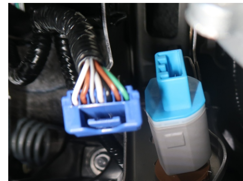
Stecker am Bremslichtschalter.
